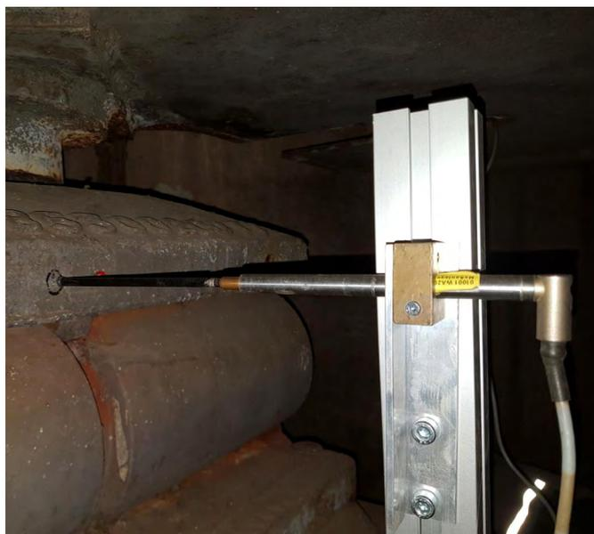
*Bild 2-7 Installation Dehnmessstellen an den Trapezhohlsteifen und Wegsensoren an den Lagern*
