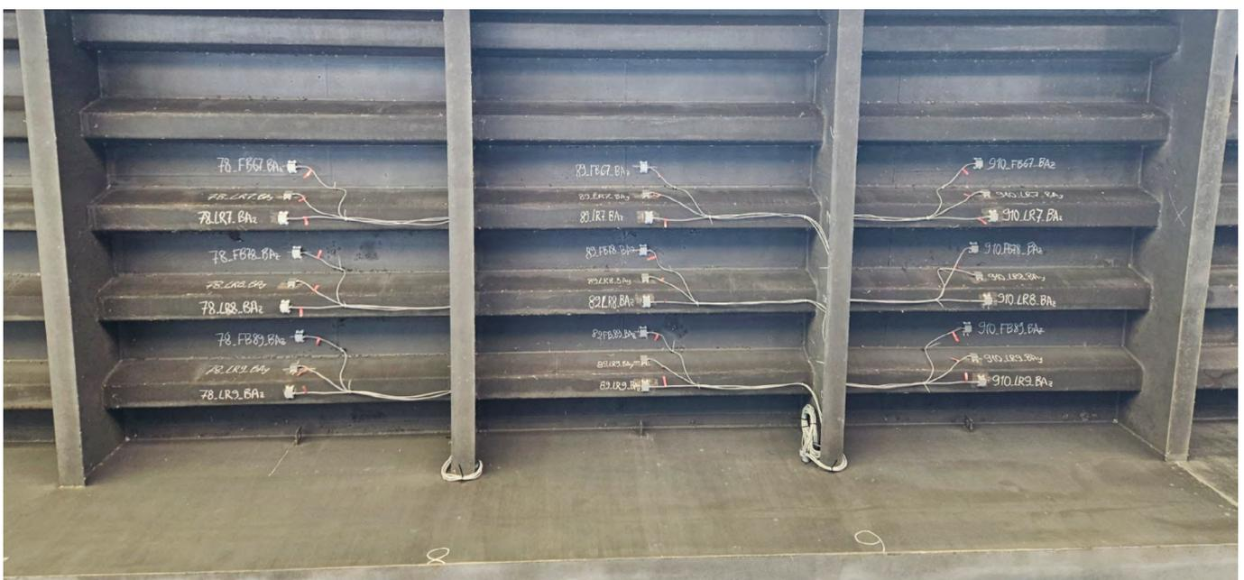
Bild 5-7 Zur Verdichtung des Monitoringsystems zusätzlich installierte Beschleunigungsaufnehmer
